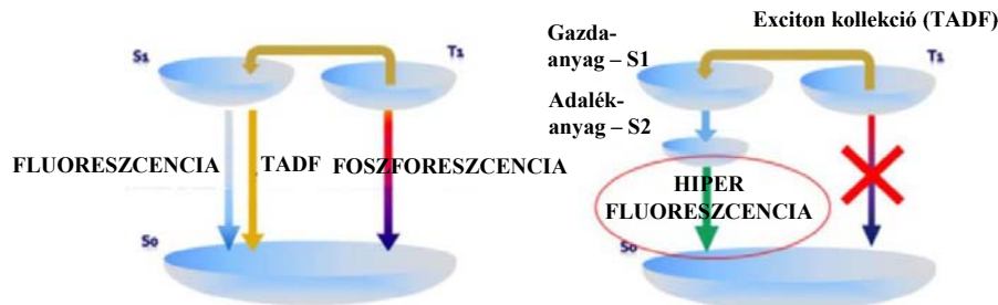
6-3. ábra – A TADF termikusan aktivált késleltetett fluoreszcenciás és a hiperfluoreszcencia mechanizmusainak összehasonlítása [41]
