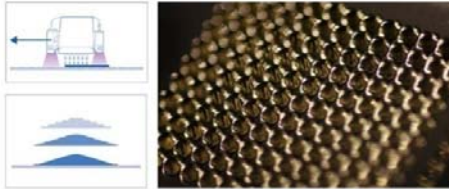
5-15. ábra – UV nyomtatófej „anyagcseppeinek” leválasztása a hordozó anyagára (bal felső ábra). A polimercseppek a felszíni feszültség hatására szétterülnek az UV-fénnyel történő kikeményítés előtt az optikához szükséges síma felület elérése érdekében (bal alsó ábra). Mikrooptikai lencsetömbök (jobb oldali ábra) [28]
