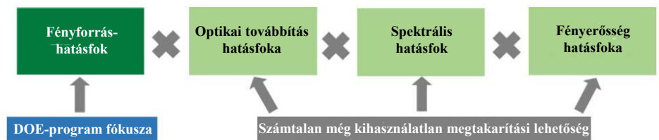
4-2. ábra – Lehetséges módszer a világítási alkalmazás hatásfokának kiértékeléséhez
